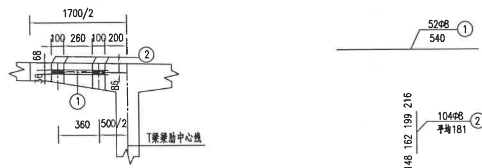
连续段钢束定位网侧面布置
